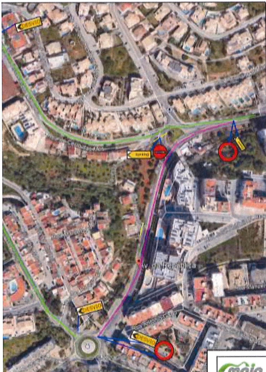
Figura n.º 2 - Fase 2 dos trabalhos na Avenida da República com corte de via e desvio de trânsito
